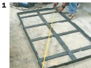
2. "Pointer" les différents éléments entre eux par deux points de soudure.
