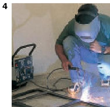
5. Positionner les éléments d'un pied sur le plan et tracer les points d'assemblage avant de procéder au pointage à la soudure.
